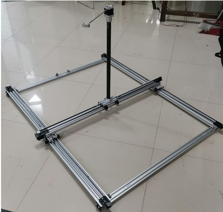
图 3-4 自动测量系统的机械部分
